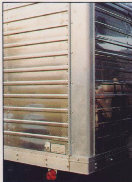
Coluna reforçada e canto fundido em alumínio
