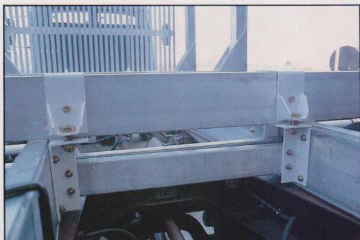
Detalhe da fixação dos garfos na carroceria para transporte no sentido longitudinal
