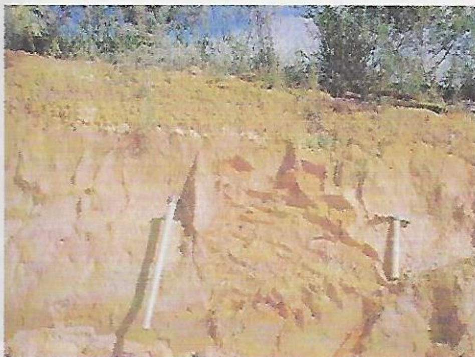
Figura 4.1-15 Vista de solo transportado (colúvio), siltico-argiloso, poroso, de cor marrom escura, espessura inferior a 1 m, separado por stone line de quartzzo na base, com solo residual maduro (abaixo) com textura da rocha original.
