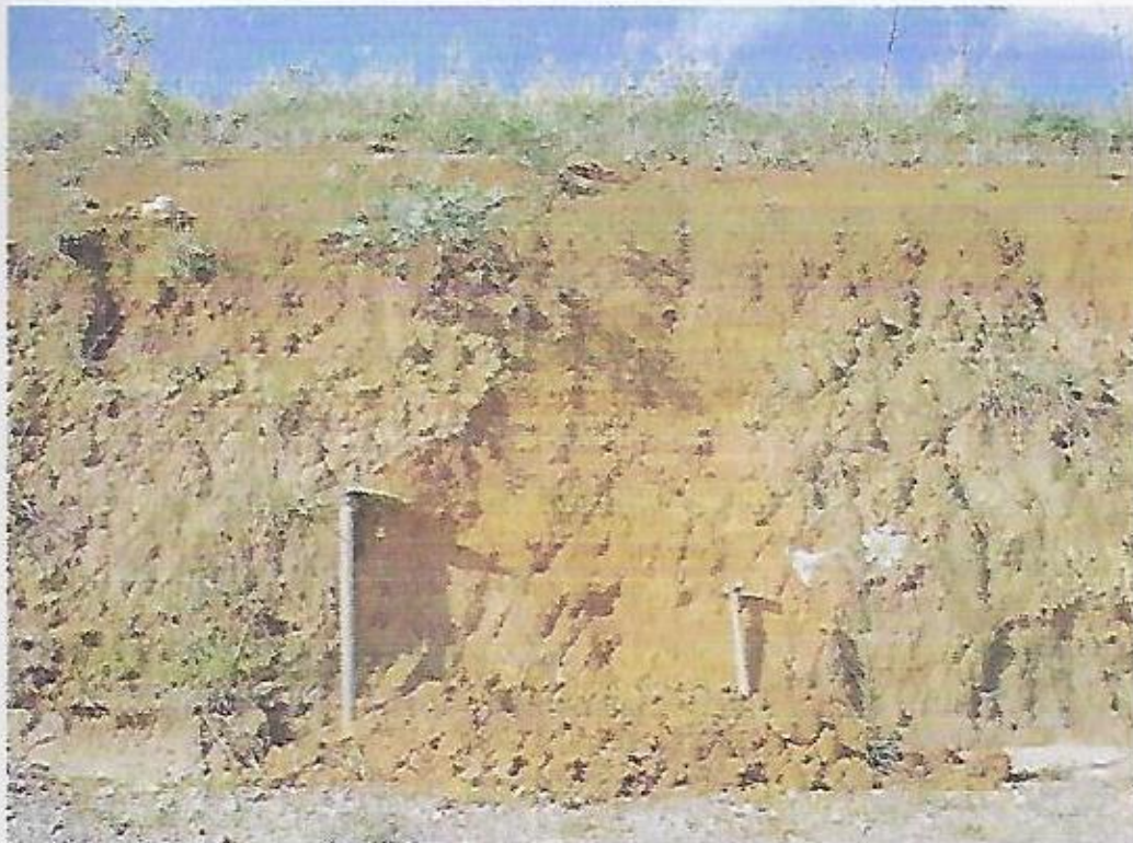
Figura 4.1-12: Vista de solo residual sobre rochas gnáissicas-migmatíticas, com 1,5 m de espessura, textura siltosa a média e cor castanha clara a amarela.
