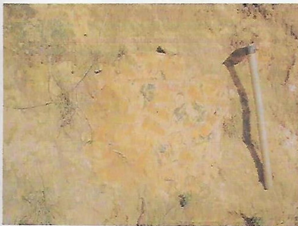
Figura 4.1-9 Vista de saprolito de cor avermelhada pardacenta ou variegada, com textura siltosa, por vezes média, e espessura superior a 5 m.
